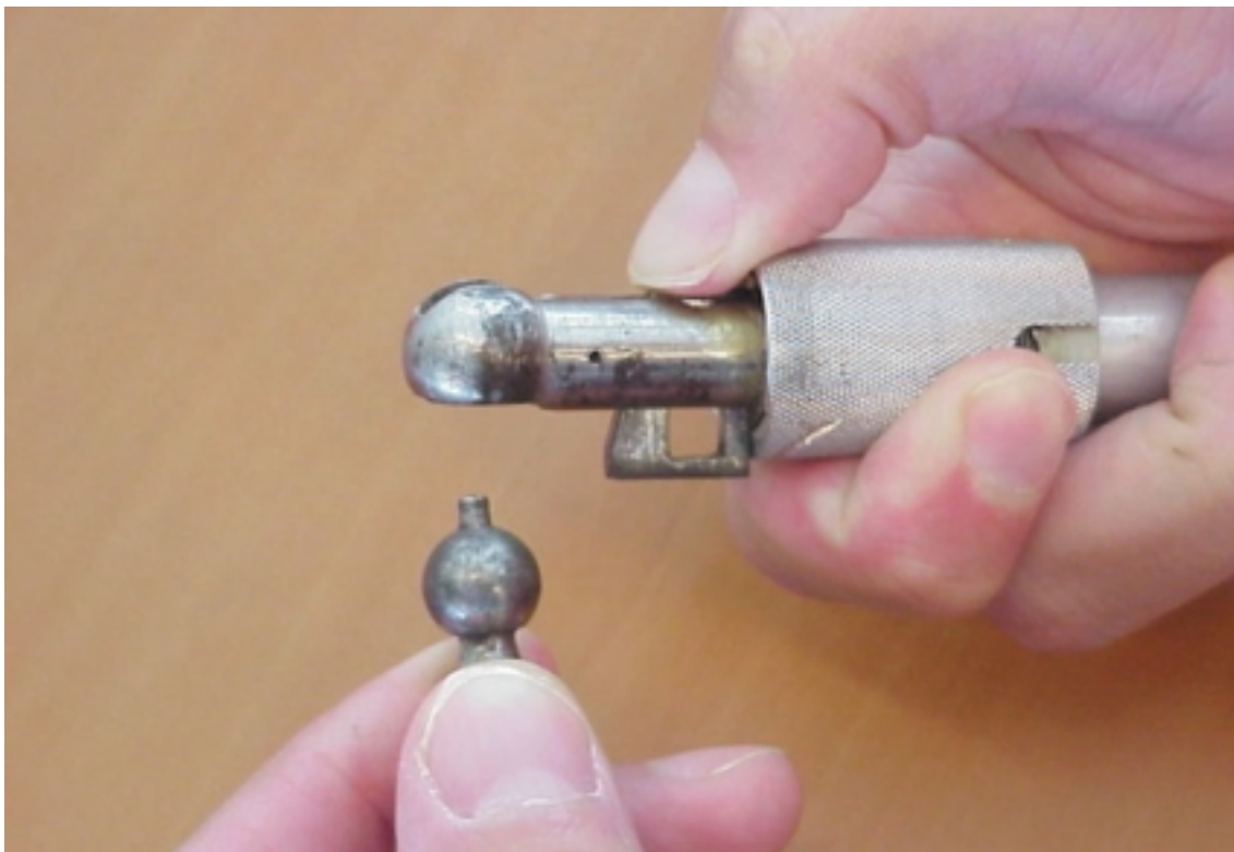
4. Het bevestigen van een l'Hotellier snelsluiting met Wedekind borghuls.
