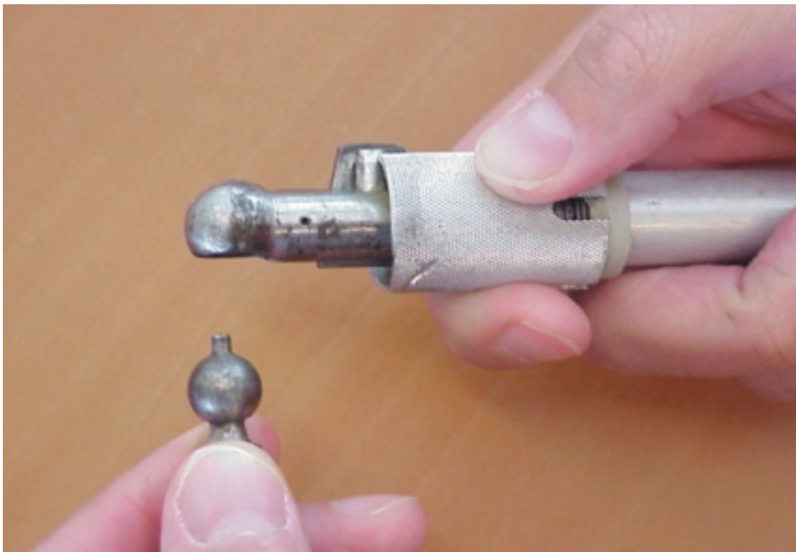
3. Het bevestigen van een l'Hotellier snelsluiting met Wedekind borghuls.
