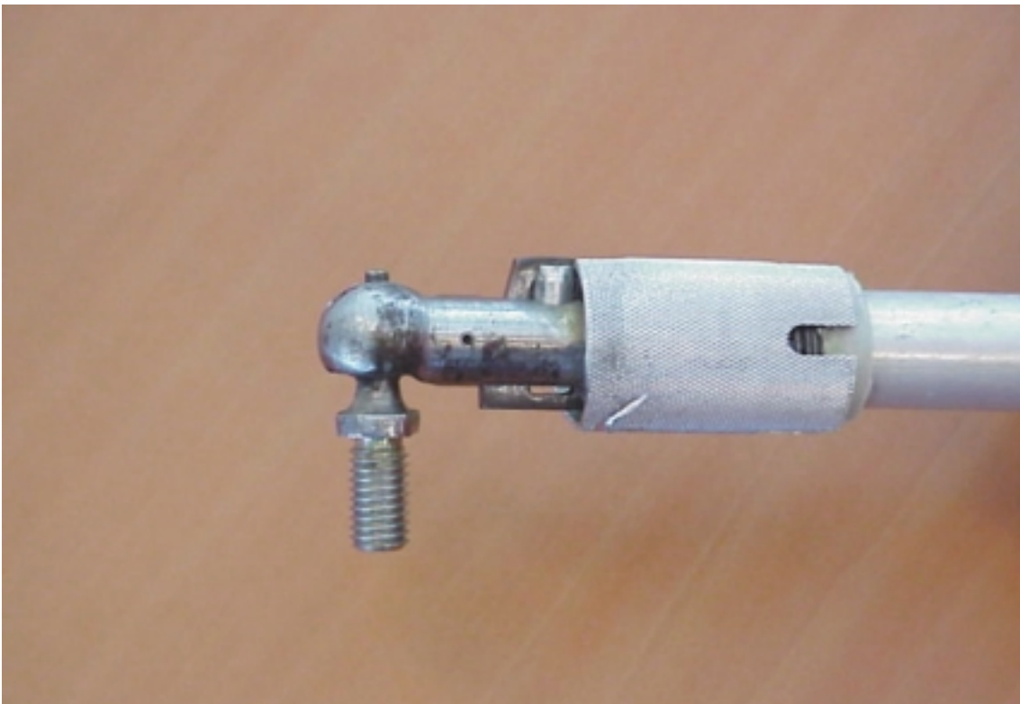
6. Het bevestigen van een l'Hotellier snelsluiting met Wedekind borghuls.
