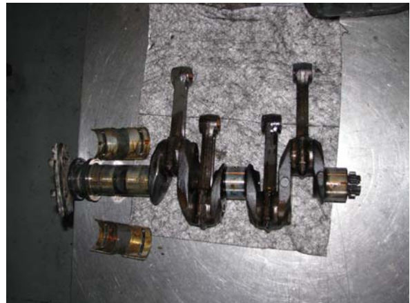
Foto 27: albero motore bielle e bronzine.
