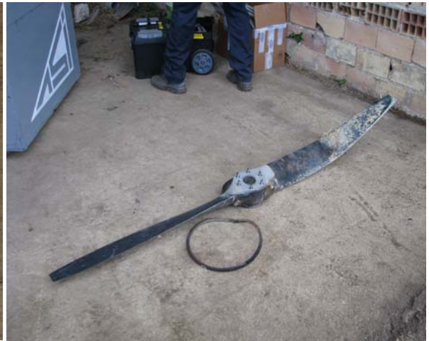
Foto 19: deformazione pala elica.
