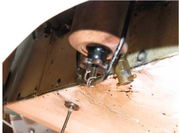
Foto 17: filtro drenaggio efficiente con frenatura.
