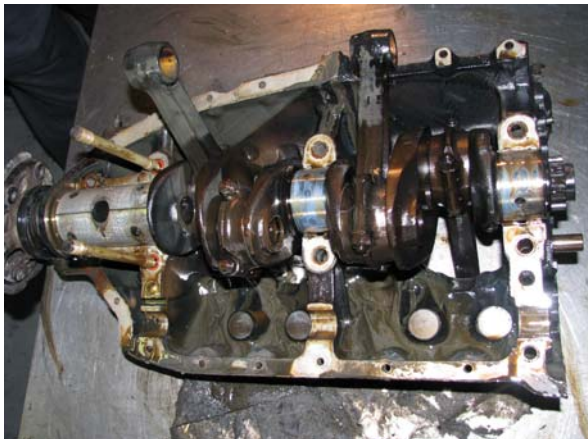
Foto 26: interno del carter motore.
