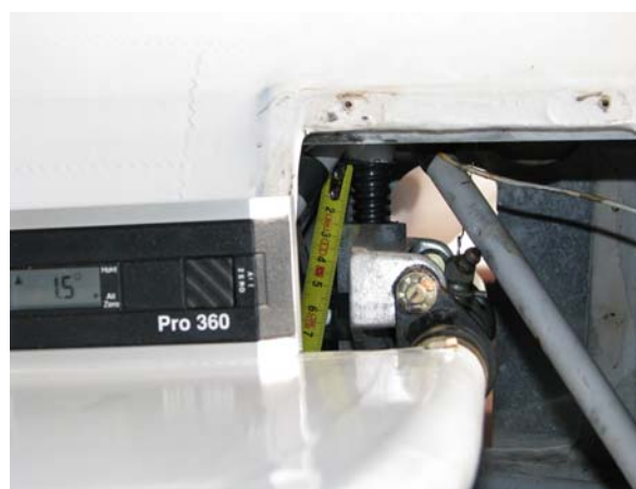
Foto 15: misura angolo stabilizzatore.
