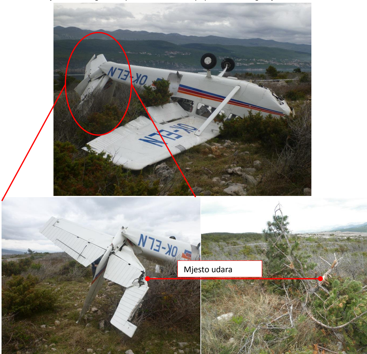
Slika 1.6. Lom repnog dijela trupa
