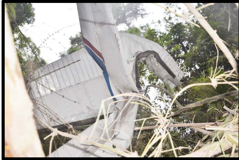
Fotografía No. 05 Vista del empenaje con daño severo en el empenaje.
