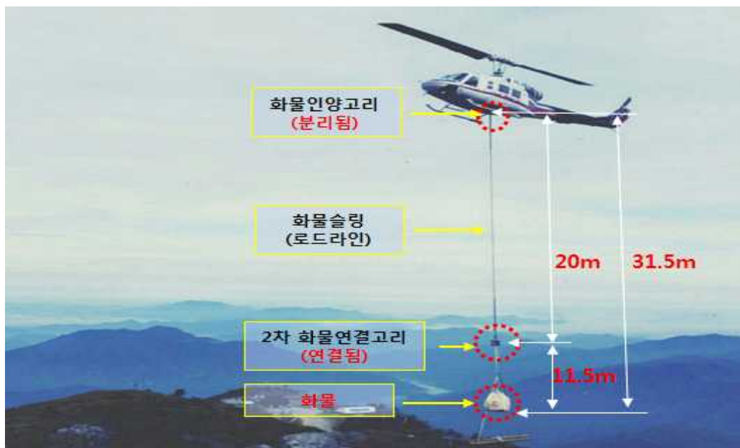
[그림 13] HL9157 외부화물인양장치 구성 및 화물 길이
