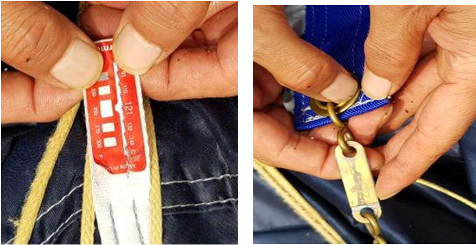
[그림 5] 열기구 내부 열감지인식표 및 과열경고 리본
