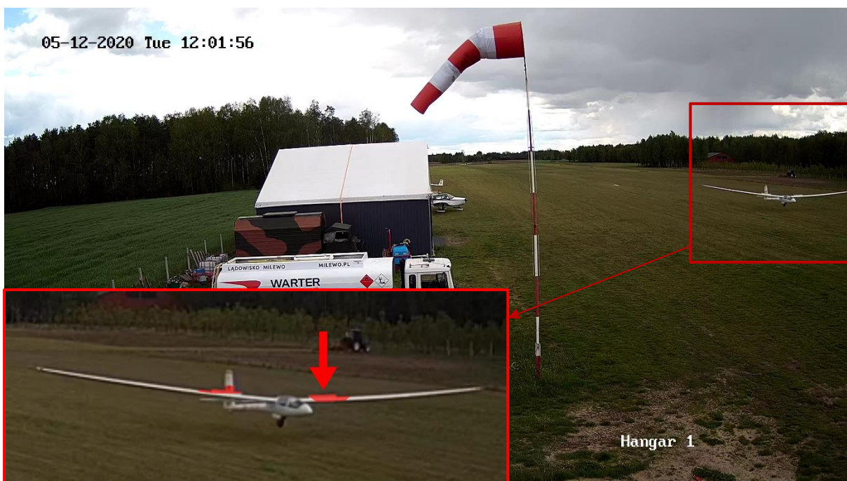
Rys. 1. Widok lądowiska z kamery monitoringu 1 – szybowiec po oderwaniu (widoczne pełne wysunięcie płyt hamulców aerodynamicznych na skrzydłach szybowca) [źródło: monitoring]
