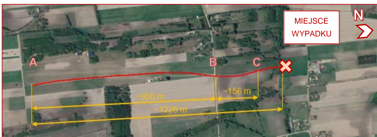
Rys. 2. Trajektoria lotu szybowca po starcie – na podstawie danych z rejestratora [źródło: Google Earth, PKBWL]
